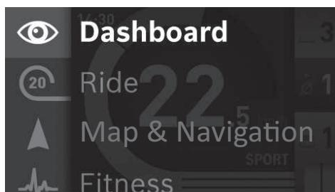
Naciskając dżojstik (1) w lewo, można wyświetlić Menu główne, które nałoży się na aktualnie wyświetlany tryb (zob. rys. powyżej).
