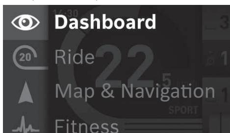
Prin apăsarea și ținerea joystick-ului (1) pe stânga și apăsarea joystick-ului spre dreapta (1), ecranul curent este acoperit de opțiunile de setare posibile în modul de funcționare curent. Navigați cu ajutorul joystick-ului la opțiunea dorită și selectați-o prin apăsarea joystick-ului (1).
