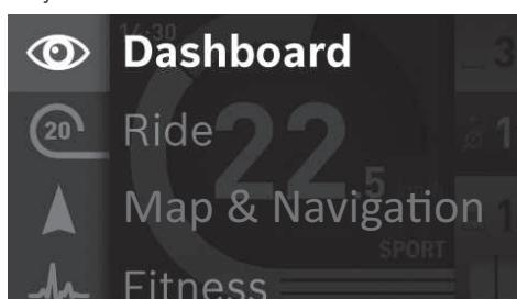
Pomocí joysticku (1) můžete stisknutím doleva aktivní provozní režim překrýt hlavní nabídkou a přejít do hlavní nabídky (viz obrázek výše).
