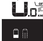
Ha az eBike-ba két akku van behelyezve, és mindkettőt a kerékpáron tölti, akkor a kijelzőn mindkét akku töltésének előrehaladása megjelenik (az ábrán éppen a bal oldali akku töltése folyik). Az akku villogó jelzéséről megismerheti, melyik akku töltése folyik éppen.
