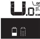
Ak sa na eBike s dvomi vloženými akumulátormi nabíjajú obidva akumulátory na bicykli, potom sa na displeji zobrazuje postup nabíjania oboch akumulátorov (na vyobrazení sa nabíja práve ľavý akumulátor). To, ktorý akumulátor sa práve nabíja, môžete zistiť podľa blikajúceho indikátora na akumulátore.
