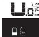
Pokud se u systému eBike se dvěma nasazenými akumulátory na jízdním kole nabíjejí oba akumulátory, na displeji se zobrazuje postup nabíjení obou akumulátorů (na obrázku se právě nabíjí levý akumulátor). To, který z obou akumulátorů se právě nabíjí, poznáte podle blikajícího ukazatele na akumulátoru.
