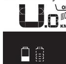
Jeżeli w rowerze elektrycznym z dwoma akumulatorami ładowane są obydwie akumulatory, na wyświetlaczu pojawia się wskazanie postępu ładowania dla obydwu akumulatorów (ilustracja pokazuje ładowanie lewego akumulatora). Migający wskaźnik na akumulatorze pokazuje, który z dwóch akumulatorów jest aktualnie ładowany.
